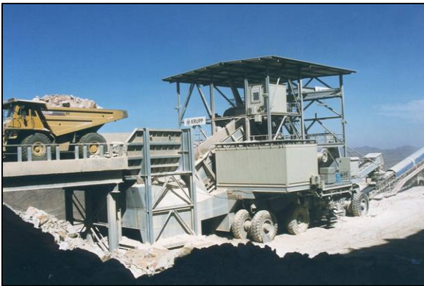
Bild 2: Mobile Brechanlage von ThyssenKrupp Fördertechnik im Werk Bishah
