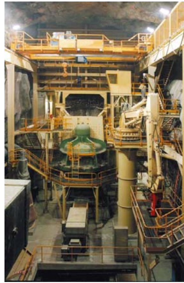
Bild 2: Kompakter Backenkreiselbrecher zur Primärzerkleinerung von Kupfererz im Block-Caving-Einsatz Untertage
